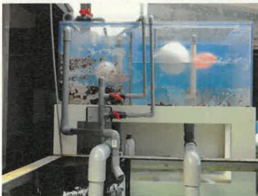
図4. スペックアップした造流装置
