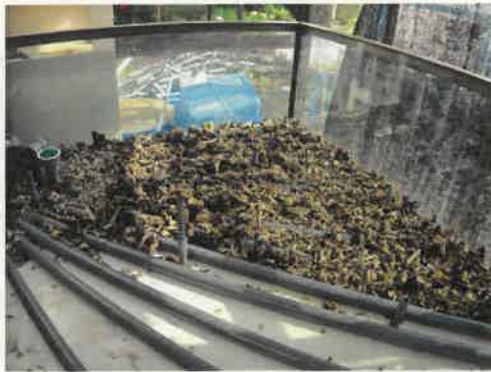
図6. 改良を加えたバッファパイプ 左：スリットが刻まれたパイプ 右：サンゴ水槽への設置状況
