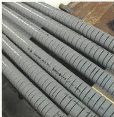
図6. 改良を加えたバッファパイプ 左：スリットが刻まれたパイプ 右：サンゴ水槽への設置状況
